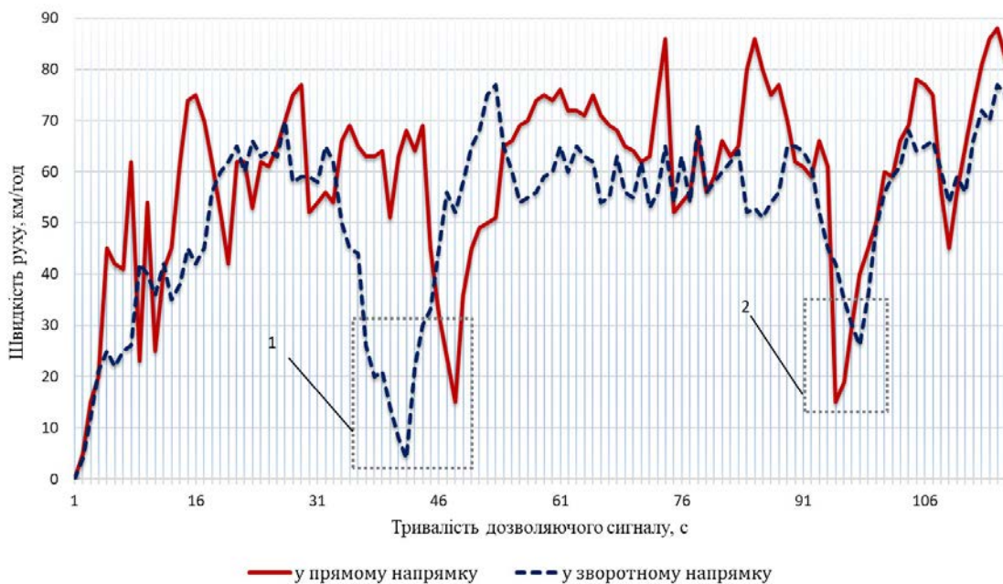
Рис. 5. Результати зміни швидкості руху на стоп-лініях головного напрямку перехрестя при появі у потоці поворотних транспортних засобів
